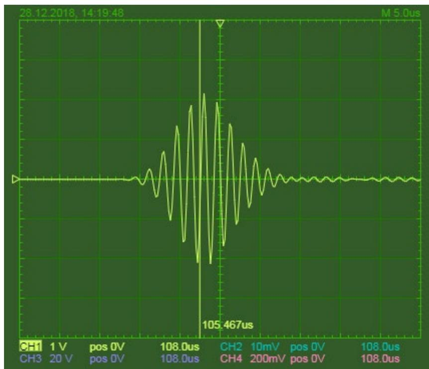
Рисунок 5 – Осциллограмма ультразвукового сигнала по образующей испытательного трубопровода, – прошедшего через приемо-передающий тракт
