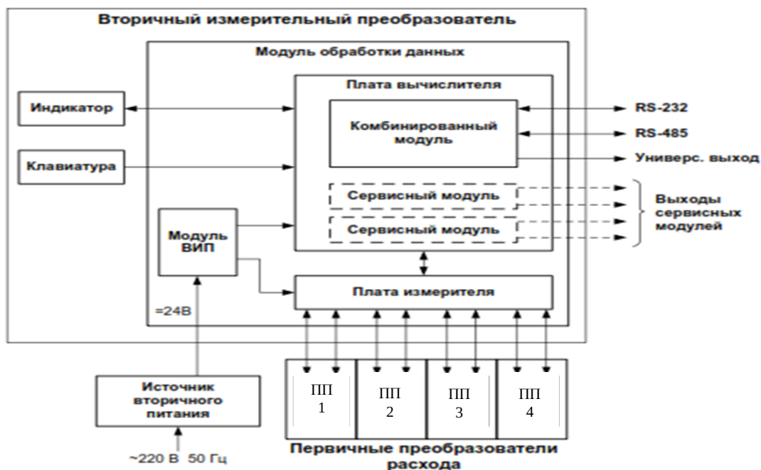
Рисунок 3 – Структурная схема расходомера
